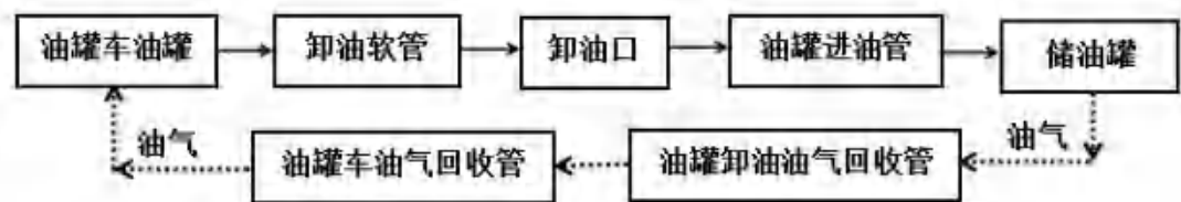
图2.4-4 汽油卸油工艺流程框图
